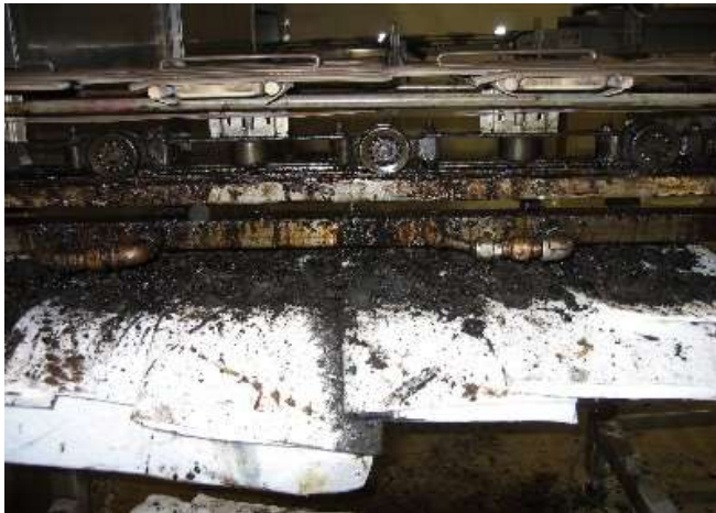
Deshecho de carbón antes de convertir a el HT-2000 con el uso de CC-2208 Limpiador de carbon.
